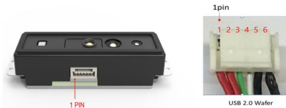
USB 2.0 Wafer 接口定义 (含 1 PIN 位置标识)
