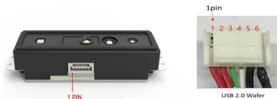
USB 2.0 Wafer 接口定义 (含 1 PIN 位置标识)
