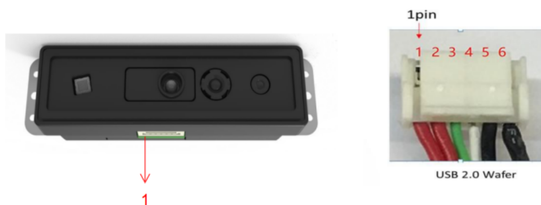
USB 2.0 Wafer 接口定义 (含 1 PIN 位置标识)
