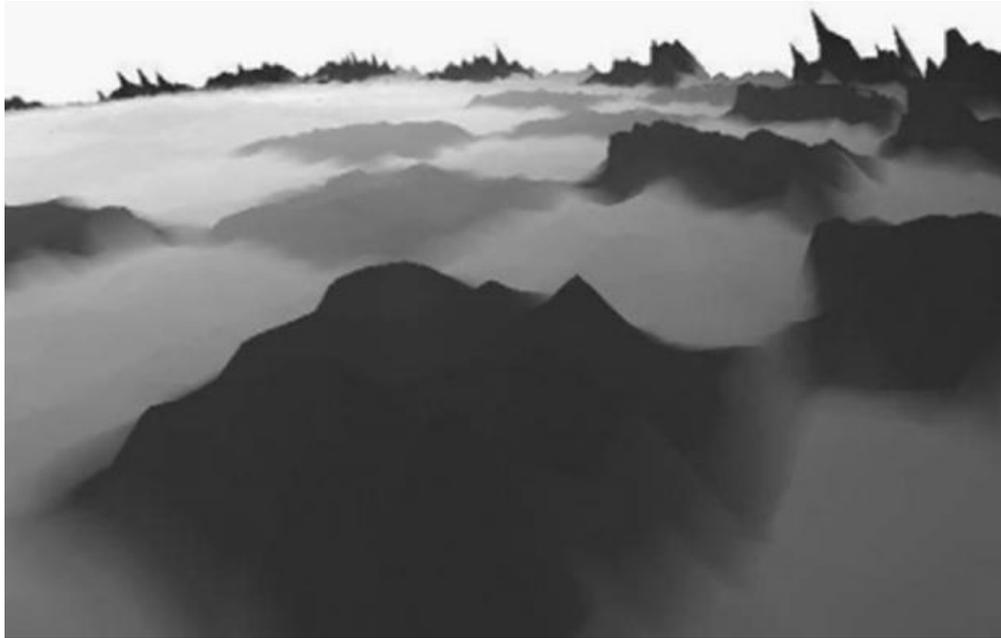
Figure 4-5 强度误差示意图，同一平面上不同反射率区域呈现不同深度，黑色和灰色区域从平面上凸起[14]。
