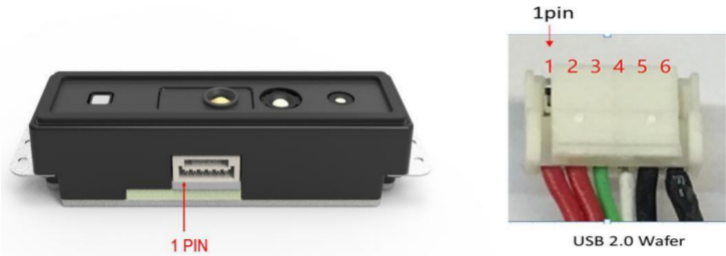
USB 2.0 Wafer 接口定义（含 1 PIN 位置标识）
