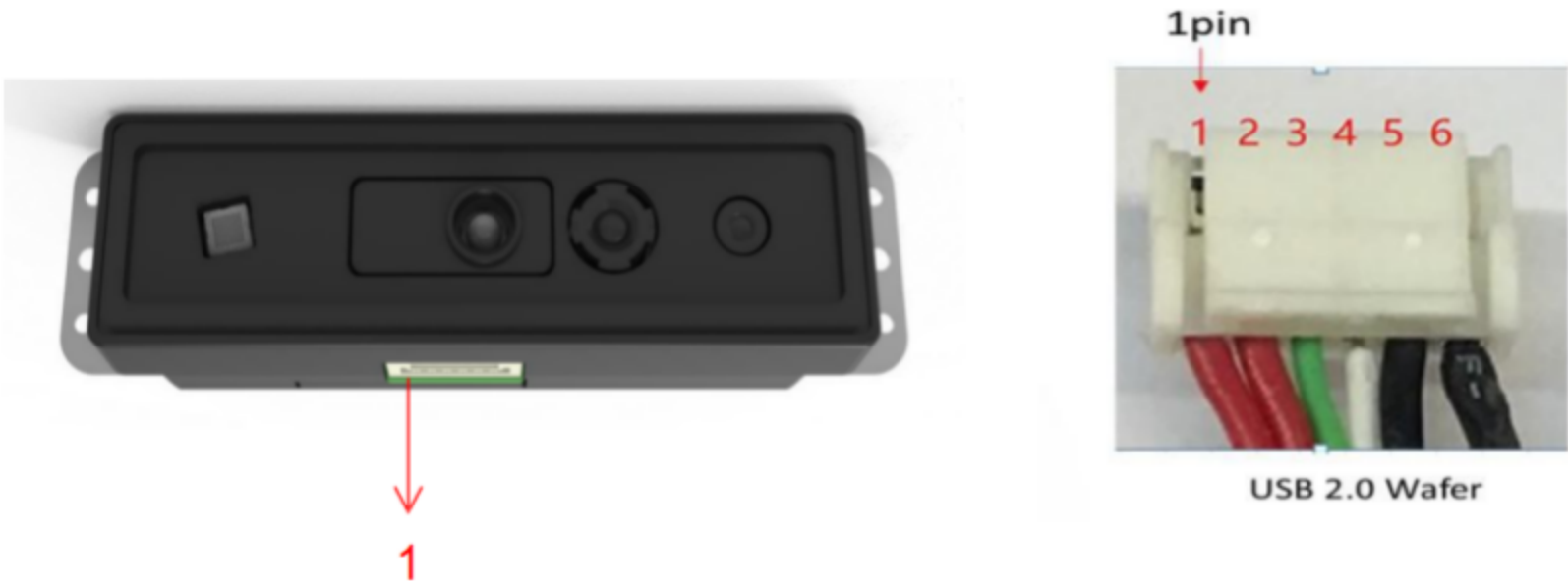
USB 2.0 Wafer 接口定义（含 1 PIN 位置标识）
