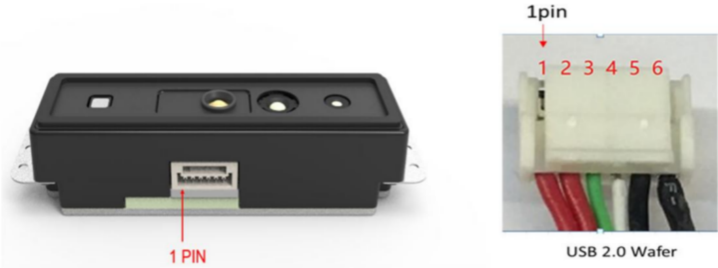
USB 2.0 Wafer 接口定义 (含 1 PIN 位置标识)
